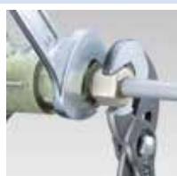
Schraubzange als zweiter »Schlüssel« bei Konterverschraubungen
